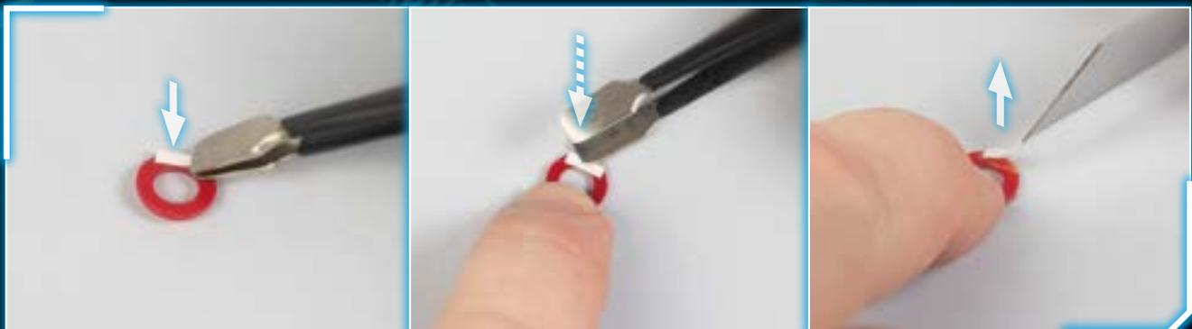
2 - При помощи пинцета поместите скотч на шайбу (30D). Слегка прижмите его, чтобы он наверняка приклеился. Затем осторожно снимите белый защитный слой, при необходимости снова используя лезвие, — сам скотч при этом должен остаться на шайбе.
